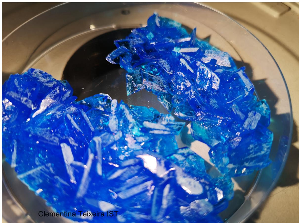
Figura 1 – Sulfato de cobre pentahidratado em placa de Petri. Cristais de cultura obtidos em laboratório por evaporação isotérmica (a temperatura baixa, constante, até 5-7°C) e em repouso. Os poliedros que podem formar, classificados em relação à sua simetria, pertencem ao sistema triclínico.
