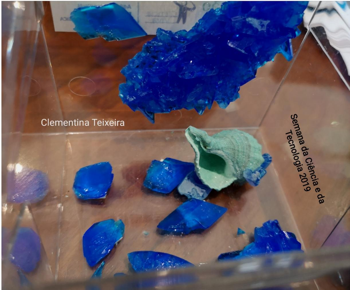
Figura 3 –  $\text{CuSO}_4 \cdot 5\text{H}_2\text{O}$  cristalizado numa concha de Múrice, a qual é atacada pela solução, ficando esta com uma cor esverdeada. Os cristais têm mais de 20 anos, e foram guardados numa caixa, ao abrigo do pó, humidade e luz. Coleção de cristais de cultura “On the Rocks”.
