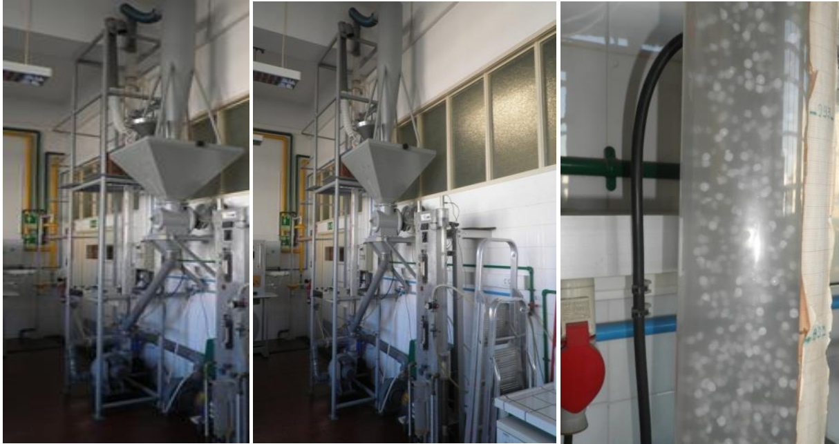
Figura 4 - Instalação de transporte pneumático - Fluidização de partículas de polímero.
