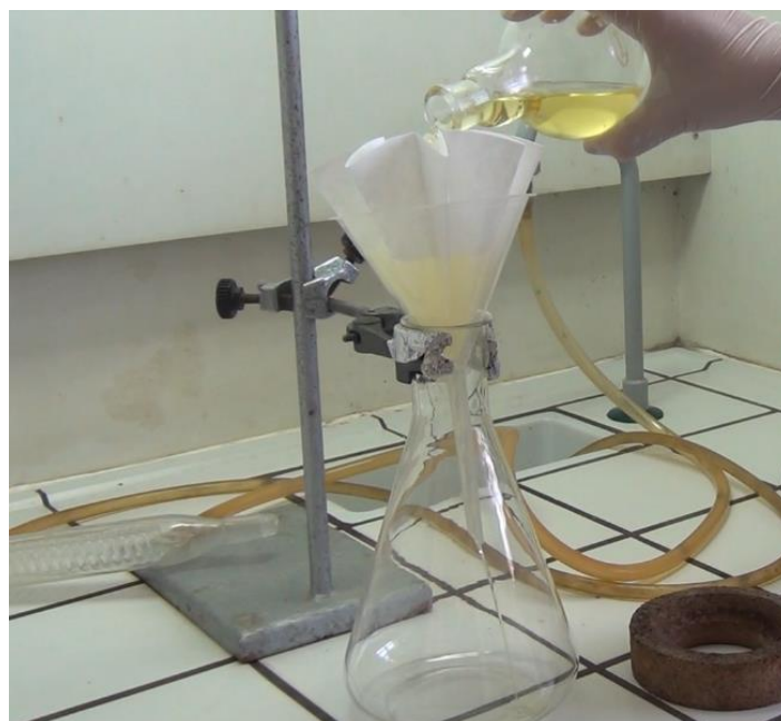
Figura 11 – Remoção de impurezas por filtração com filtro de pregas.
