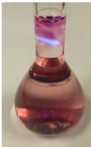
Figura 21 – Ação de um feixe de laser de cor azul numa solução do dímero I em tolueno.
