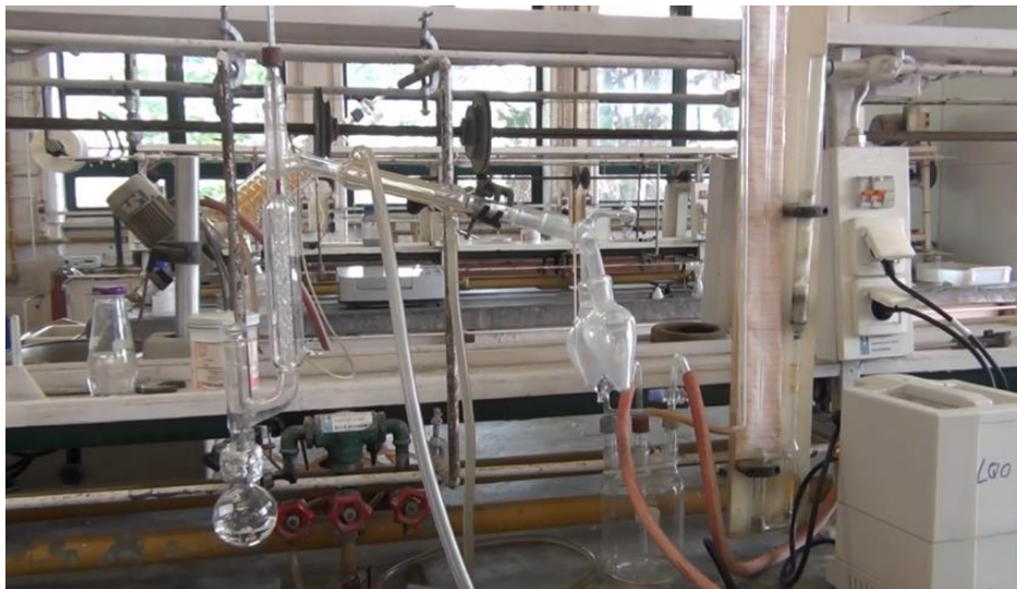
Figura 7 – Purificação do limoneno através de destilação fracionada a pressão reduzida.
