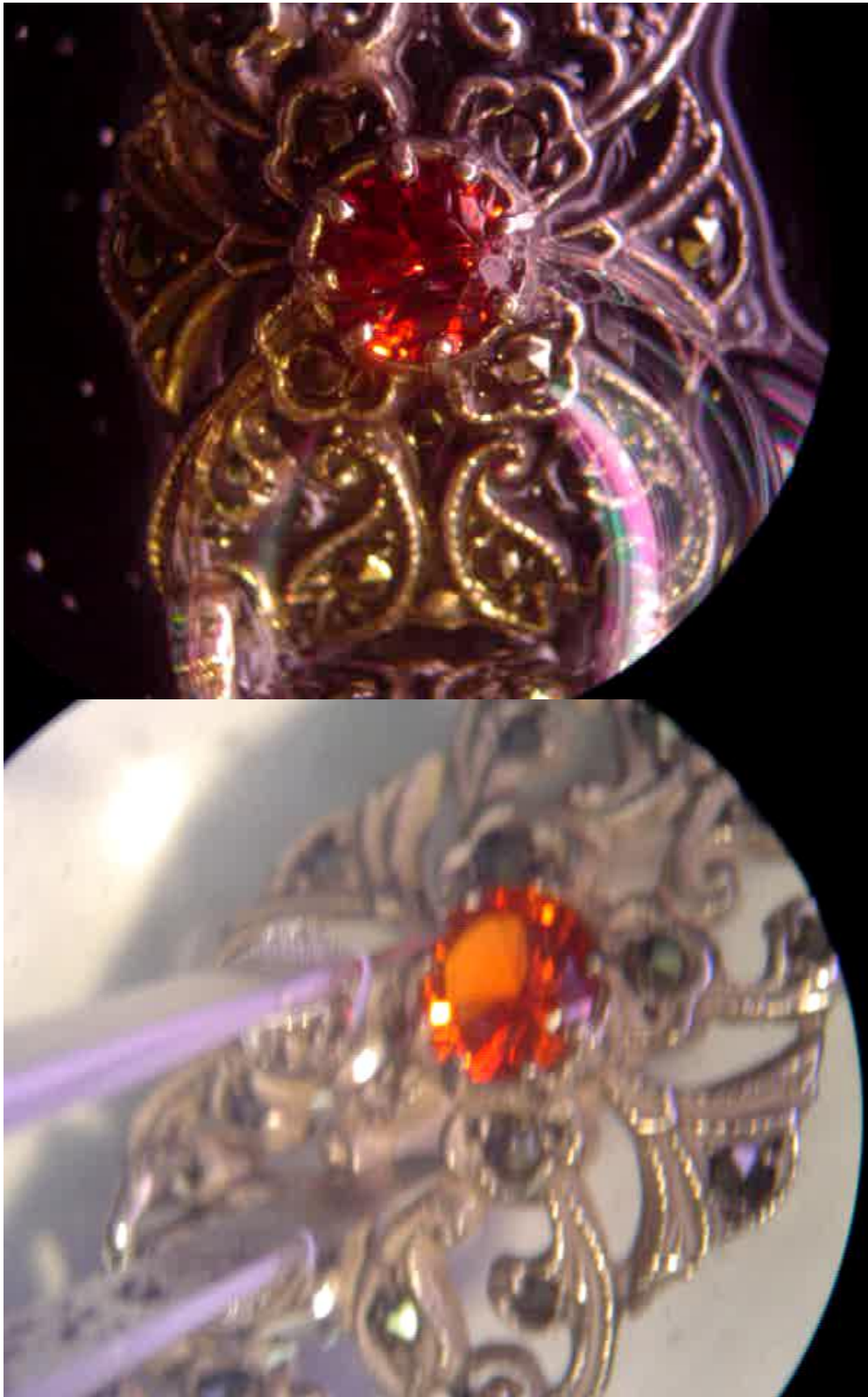
Figura 12 – Limpeza de uma pulseira de prata à lupa estereoscópica, 10x, com um preparado comercial contendo detergente. A foto macro desta pulseira foi publicada na ref. 9. Mais exemplos na ref. 4.
