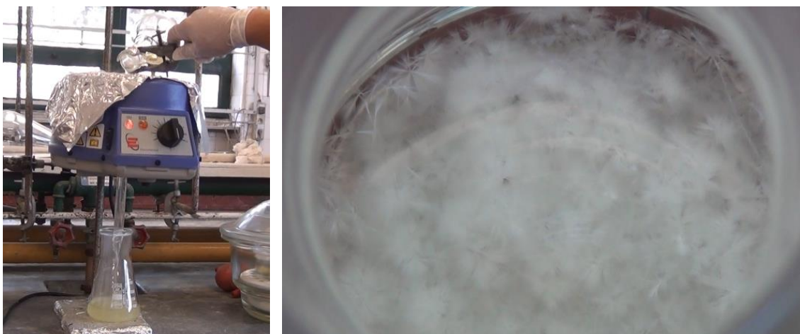
Figura 15 – Filtração a quente e precipitação dos cristais de lofina pura após arrefecimento.
