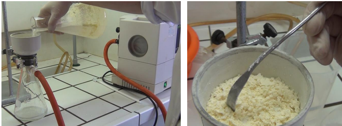
Figura 13 – Isolamento da lofina por filtração a vácuo.
