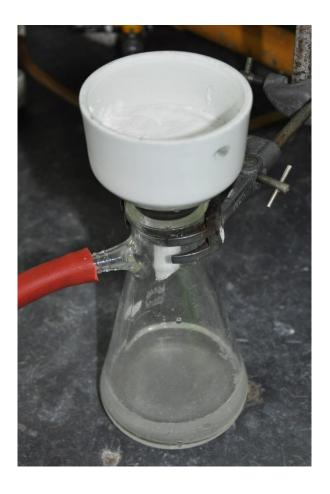
Figura 13 – Filtração em vácuo do paracetamol.
