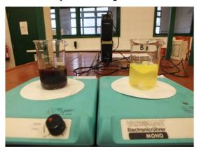
Fig. 12 – Reação relógio da vitamina C em meio reacional mais concentrado (esquerda) e mais diluído (direita).
