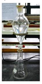
Figura 4 - Separação do eucaliptol e clorofórmio (fase orgânica) da fase aquosa
