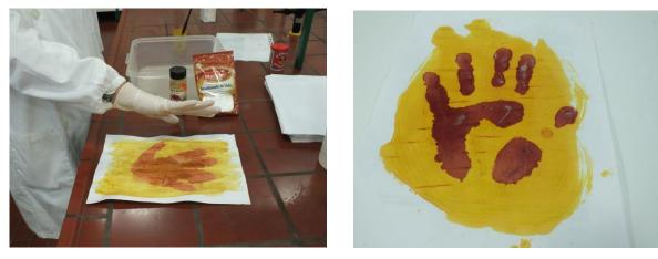
Fig. 3 – Revelação ácido-base, usando papel impregnado de açafrão.
