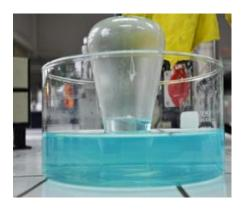
O que acontece é que o aumento da temperatura provocado pela vela acesa aumenta o volume de ar dentro do copo. Quando a vela se apaga, a temperatura diminui, resultando numa diminuição do volume de ar, que é compensada pela subida do nível de água.
