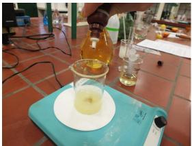
Fig. 10 – Titulação iodométrica para doseamento da vitamina C em alimentos.
