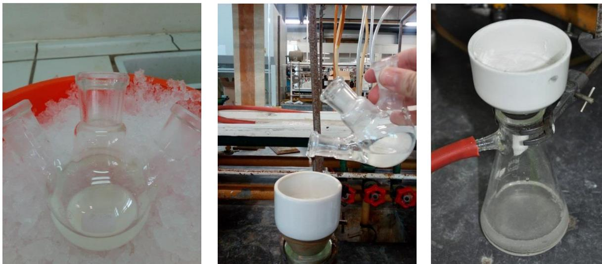
Figura 13 - Isolamento da aspirina por filtração a vácuo.
