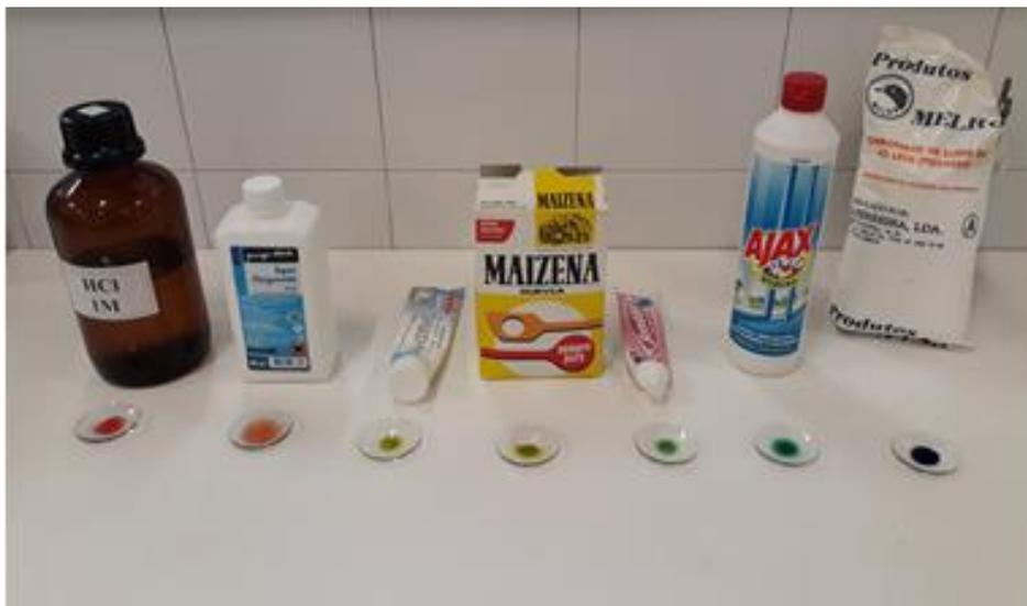
Figura 4 – Ensaio de detecção de pH em vários produtos de uso doméstico usando o indicador universal.
