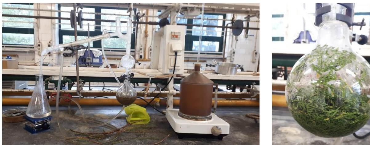
Figura 4 – Montagem da destilação por arrastamento de vapor e balão de destilação com folhas de cedro.
