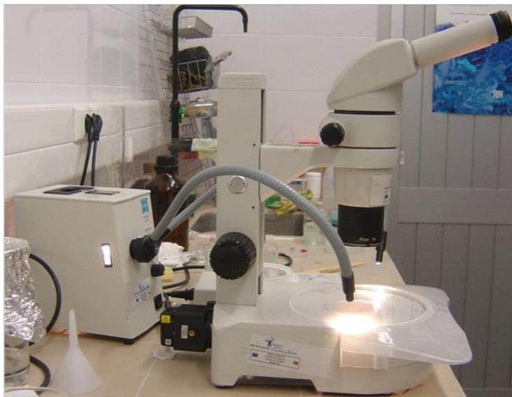
Figura 36 – Lupa estereoscópica Nikon® com base diascópica utilizada em alguns dos ensaios, com luz fria proveniente de um iluminador de fibras ópticas. Permite uma visualização tridimensional do objeto de estudo: existe uma pequena inclinação entre as oculares, de forma a que cada olho do observador capte a imagem por um ângulo diferente, sendo as duas imagens unidas pelo cérebro numa reconstrução tridimensional e única.
