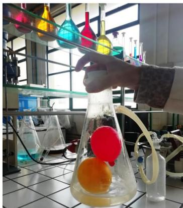
*Figura 2- Balões inchados após o vácuo efectuado no Erlenmeyer*
