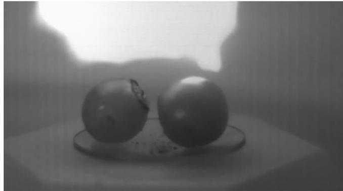
Figura 4 – Plasma de uvas [4]. Fenómeno observado quando as uvas são irradiadas num forno de micro-ondas.
