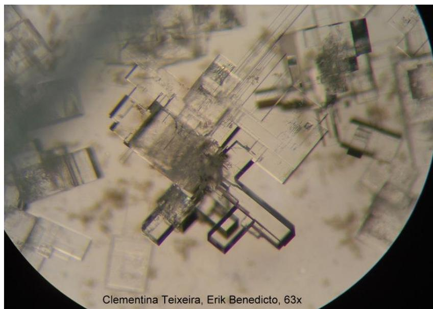
Figura 10 – Observação à lupa estereoscópica de cristais de NaCl, transição para a formação de cristais aciculares, em presença de pequenas quantidades do polímero, álcool polivinílico. O crescimento faz-se entre as cadeias poliméricas o que obriga o composto a assumir o hábito acicular. [9].
