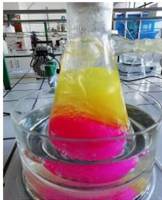
*Figura 3 - No Erlenmeyer sob vácuo a temperatura de destilação é mais baixa*
