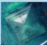
Fotomicrografia sal 7, à direita - Cristal de sal formando um cubo sem um vértice, 63x. Cristais aciculares de azul de metileno na mesma imagem. Este corante foi utilizado numa vã tentativa de colorir os cristais, inserindo o corante na rede cristalina.
