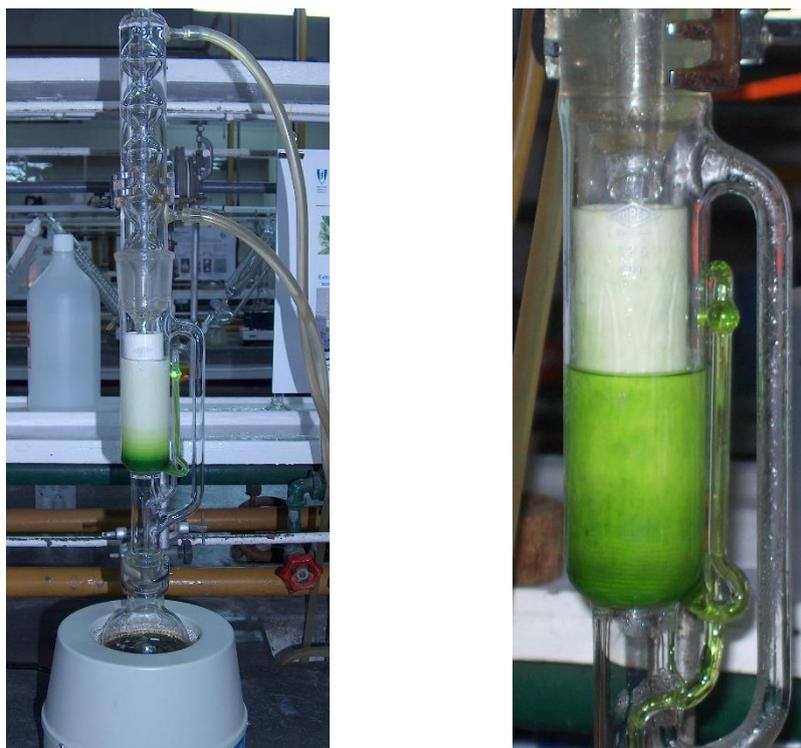
Figura 8 – Extração da clorofila em soxhlet.
