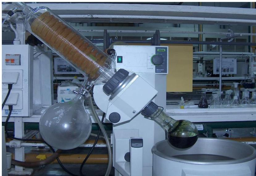
Figura 10 - Destilação do etanol num rotavapor
