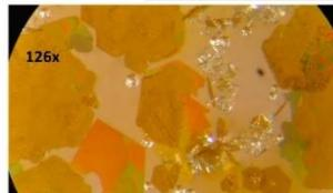
e) Reação do Pb<sup>2+</sup> (aq) com KI. Identificação de Pb, PbI<sub>2</sub>, recristalizado por fusão/ arrefecimento.
