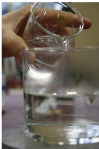
Figura 1 - Adição da solução de peróxido de hidrogénio às de iodato de potássio e de sulfato de manganês II
