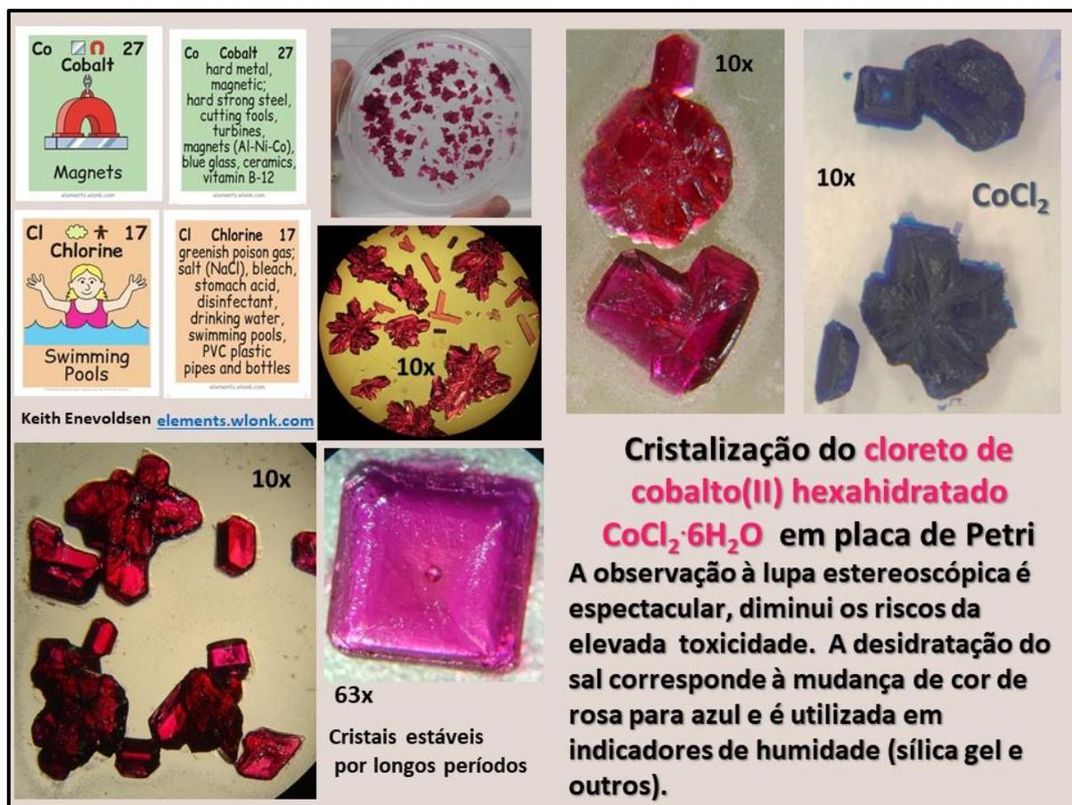
Figura 33 – Cristalização do cloreto de cobalto (2+) hexahidratado em placa de Petri e observação em 3D à lupa estereoscópica com várias ampliações [22]. Incluiu-se nesta figura o cloreto de cobalto anidro, de cor azul (“azul cobalto”) que resulta da perda de água de hidratação do composto rosa hexahidratado.
