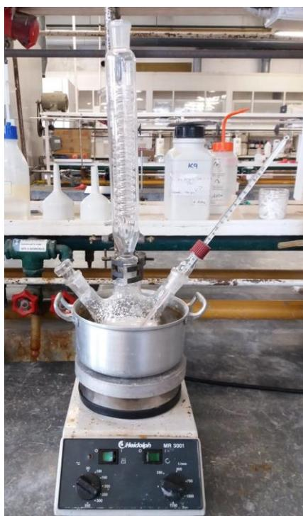
Figura 12 - Montagem para a reacção de síntese da aspirina.
