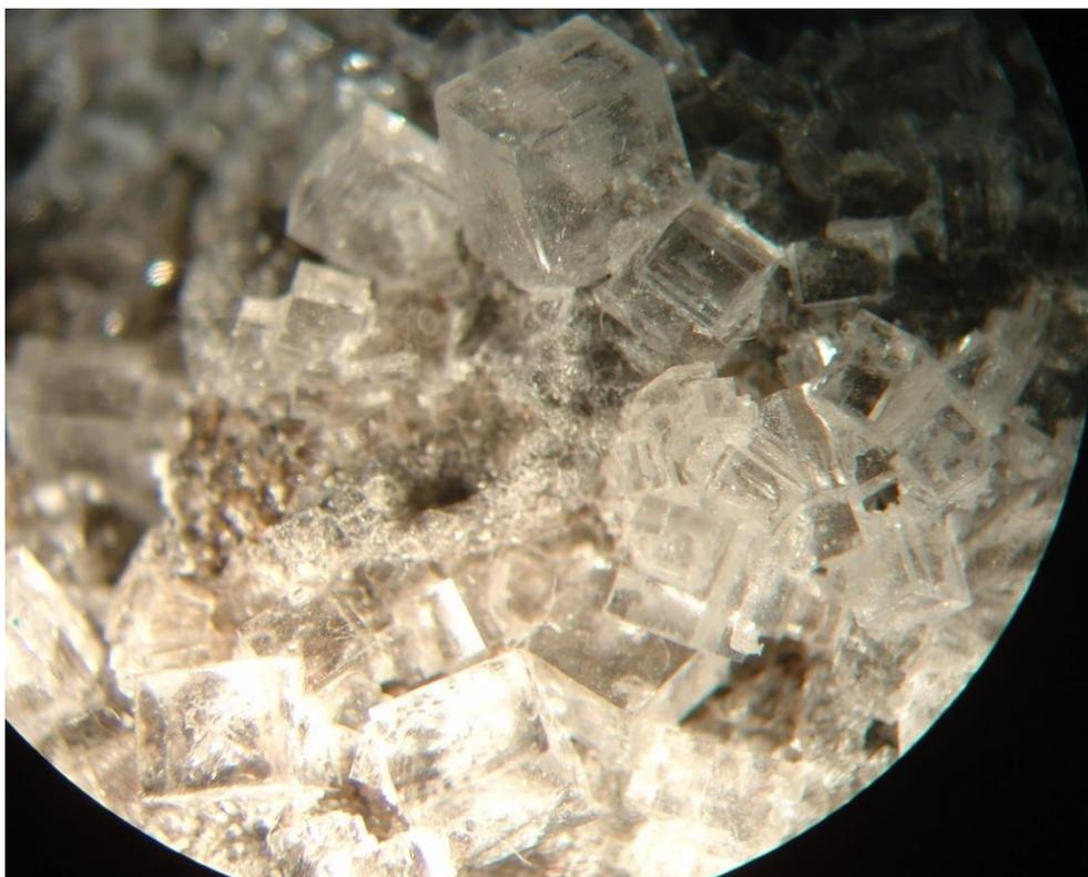
Figura 8 –Observação à lupa estereoscópica de cristais “On the Rocks” de NaCl em rocha vulcânica, 10x , solução de 15g de NaCl em 45 g de água. Método de sementeira, difícil de cristalizar [9]. Os cristais neste caso são cúbicos (utilizou-se um copo de precipitação de forma alta para o crescimento). No caso do NaCl não se verifica aumento da velocidade de crescimento em presença da rocha, o que parece ser mais vulgar acontecer com sais hidratados [10].
