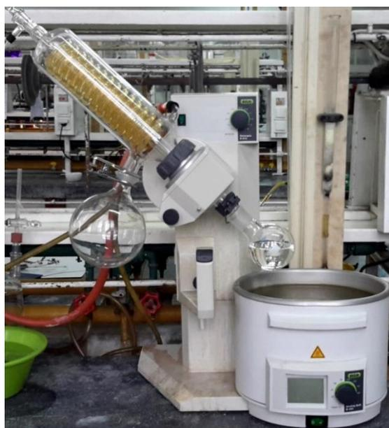
Figura 6 – Destilação do clorofórmio num evaporador rotativo.
